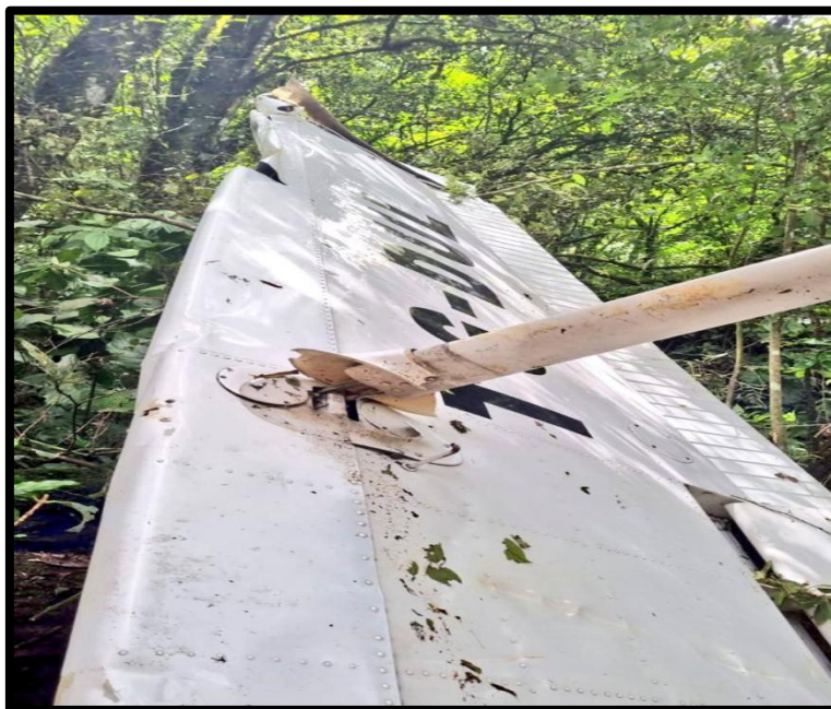
Fotografía No. 4 Vista del ala derecha separada de la aeronave.
